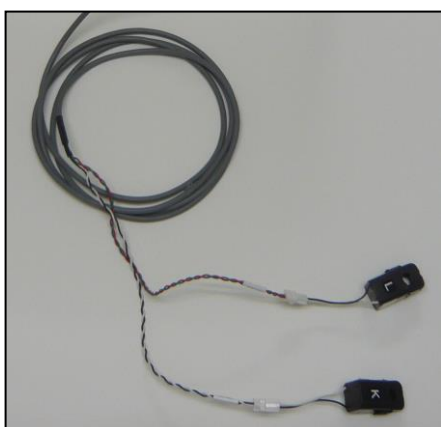
・CT用ケーブル
